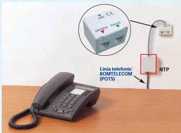
Figura 9: Splitter-ul este conectat la NTP.
