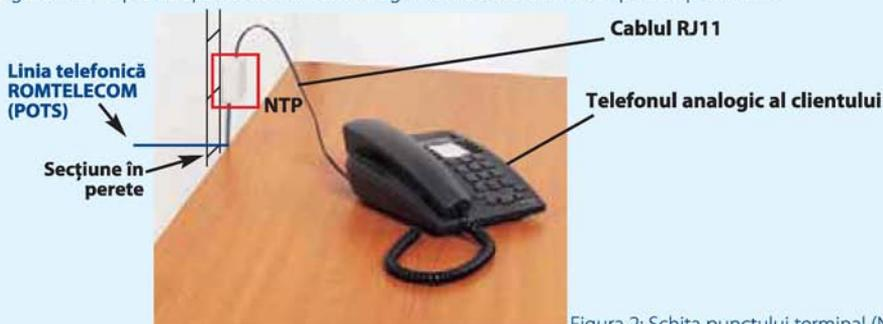
Figura 2: Schița punctului terminal (NTP).
