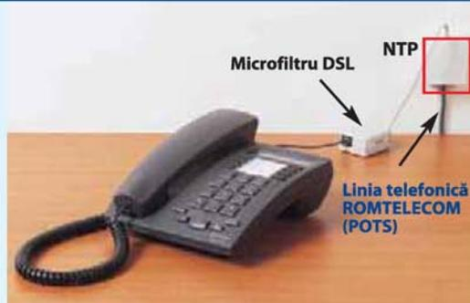
Figura 5.3: Telefonul obișnuit este conectat la priza RJ11 prin microfiltrul DSL.
