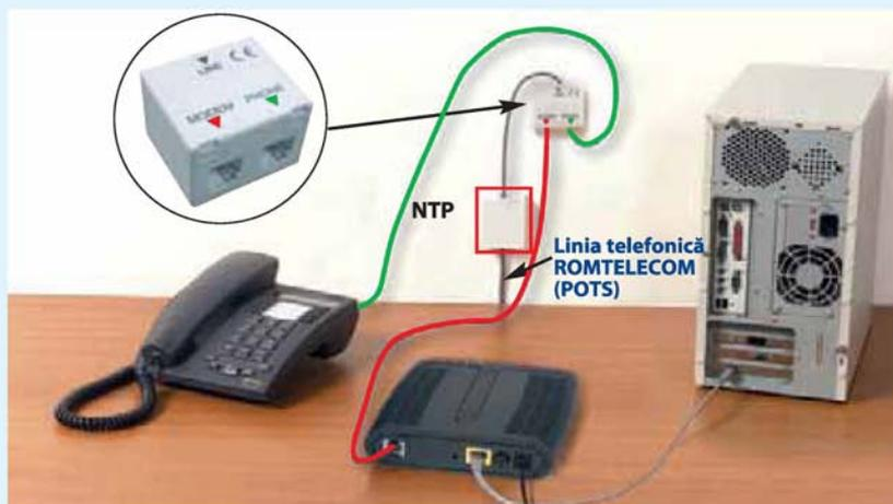
Figura 13: Finalizarea conectării dispozitivelor ADSL la linia telefonică.
